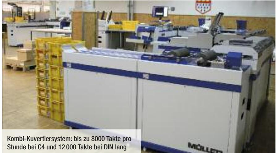
Kombi-Kuvertiersystem: bis zu 8000 Takte pro Stunde bei C4 und 12 000 Takte bei DIN lang
