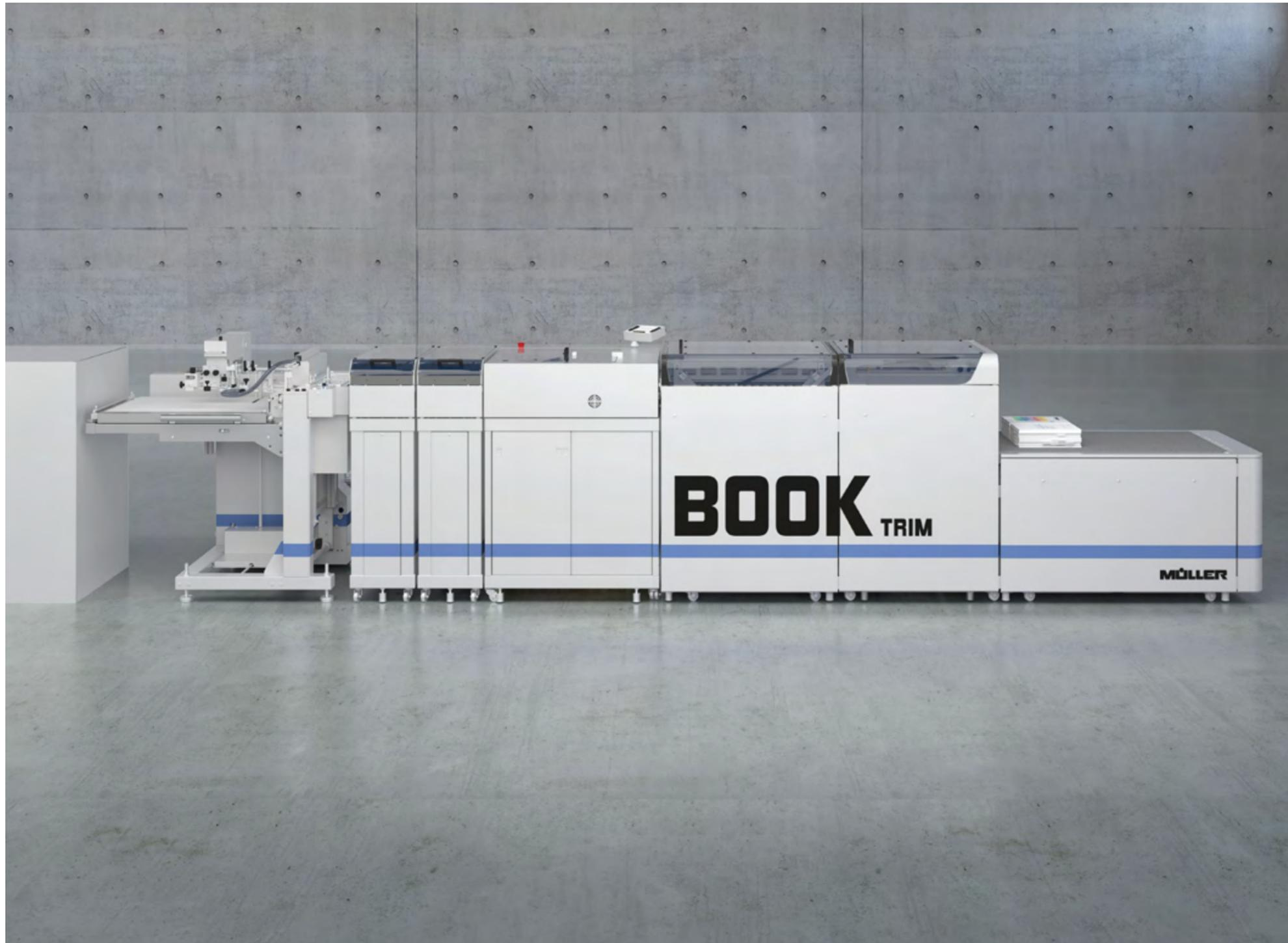
Bei Online-Verarbeitung wird der Bogen vom Drucker durch den Anleger an die Müller BookTrim übergeben. Bei Offline-Verarbeitung führt der Anleger manuell eingelegte Stapel der Müller BookTrim zu. In dieser Zeit ist der Drucker für die Produktion separater Jobs einsetzbar.
